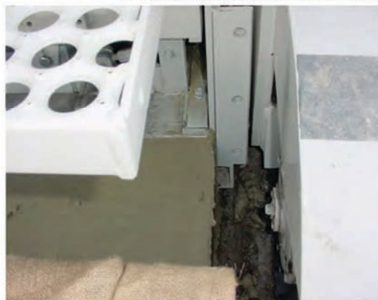
Боковые формовочные стенки соединены с шасси
