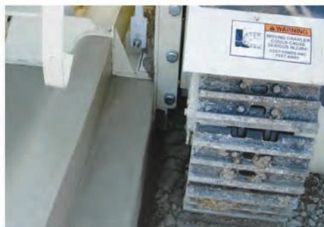
Опциональная форма позволяет интегрировать монолитный профиль с одной или по обеим сторонам укладываемого покрытия.
