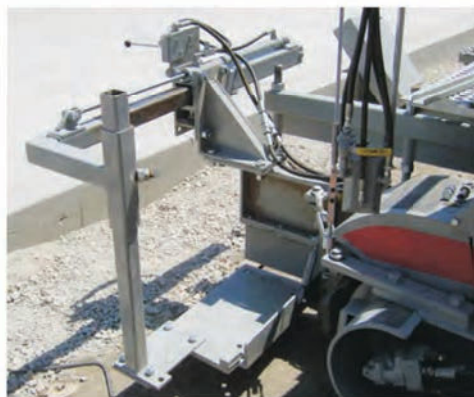
Опциональный гидравлический механизм бокового погружения арматурных стержней. Доступен и в механическом исполнении
